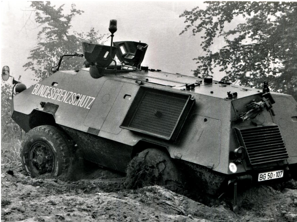
Im Gelände mit Ketten (Mittig: 2 flügelige Einstiegluke, danach: Motorluft- und Kühlluft-ansaugung, dann: Motorwartungsklappe, am Heck: Kühlerabluft, darüber der Wagenheber)
