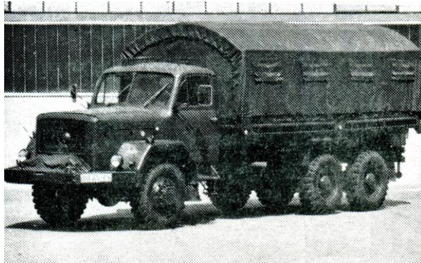
Magirus Deutz Jupiter 6 x 6 Kfz 30/3 gl Motor: Diesel, 12.667 cm 3 , 125 kW / 170 PS Luftkühlung Allradantrieb, Schaltgetriebe unsynchronisiert
